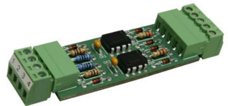
■ Pegelwandler / HTL -> RS422 Zur Wandlung herkömmlicher Inkrementalgebersignale für NEW-Schachtkopierung
